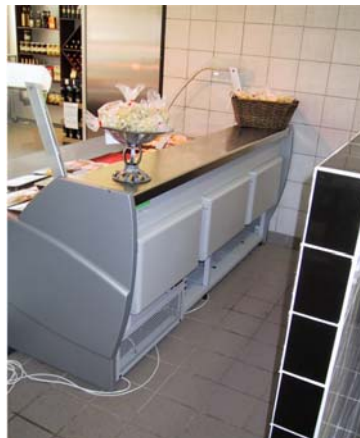
Selvbetjeningsdisk - set bagfra, med kølede magasiner
